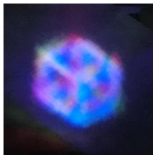
図3 3次元体積像の表示結果 左：3台のプロジェクタを用いたディスプレイシステムによる表示 右：拡大光学系を適用させたディスプレイシステムによる表示
