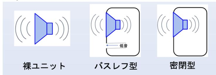
Figure 2 エンクロージャの有無・種類によるスピーカ単体の放射特性
