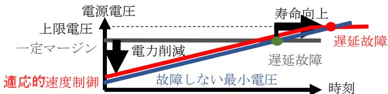
図 1：適応的速度制御の動作の推移
